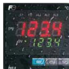
El display y la sección de manejo frontales son impermeables de acuerdo con la norma NEMA-4 X:IP66. Por tanto, en panel frontal puede lavarse con agua (es preciso utilizar el paquete de impermeabilidad adjunto).
