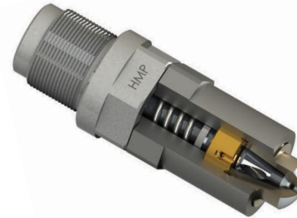
La boquilla de muelle interno es automática y mecánica, utiliza el movimiento de la prensa. Cuando se realiza la inyección la presión empuja la aguja hacia atrás, comprimiendo el muelle y la materia fluye. Cuando baja la presión de inyección el resorte empuja la aguja y obtura.
